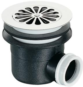
Bonde à grille pour receveur D90mm avec raccord à visser ou à coller, sortie horizontale, chromé
