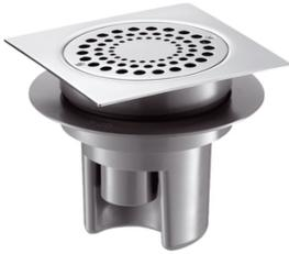
Débit 36 l/min normalisé. Garde d'eau 50 mm. Platine et grille Inox poli brillant 150 x 150 mm. Sortie horizontale ou verticale Ø 40 intégrée dans la hauteur du siphon (gain de hauteur et orientation toute direction). Colletette d'étanchéité intégrée pour collage de membrane isolante.
