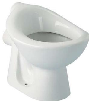
Cuvette indépendante Maternelle Contour 21 blanc en porcelaine vitrifiée. Bride ouverte. Fond creux. Assise ergonomique à bord rond sans trou d'abattant. Sortie horizontale Ø8,5 cm. Sans réservoir, alimentation indépendante. Fonctionne à 4,5 litres. Fixation au sol par 2 vis. Raccordement par joint type Sirius N° 4. Hauteur de la cuvette 30 cm. A équiper d'un réservoir semi-haut.
