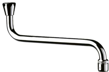
Bec orientable mural. Brise-jet réglé à 3 l/min. F1/2".
