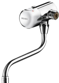
pour douche à l'italienne DOMAO. Débit pré-réglé à 3 l/min à 3 bar, ajustable de 1,5 à 6 l/min.
