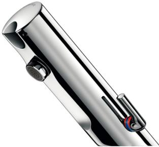
Alimentation par piles 123 Lithium 6 V intégrées. Electrovanne antistagnation et module électronique intégrés dans le corps de la robinetterie. Débit pré-réglé à 3 l/min à 3 bar, ajustable de 1,5 à 6 l/min. Brise-jet antitartre.
