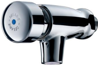
Temporisation ~7 secondes. Débit pré-réglé à 3 l/min à 3 bar, ajustable de 1,5 à 6 l/min. Brise-jet antitartre inviolable. Corps en laiton massif chromé M1/2". Système antiblocage AB : écoulement uniquement lorsque le bouton poussoir est relâché.
