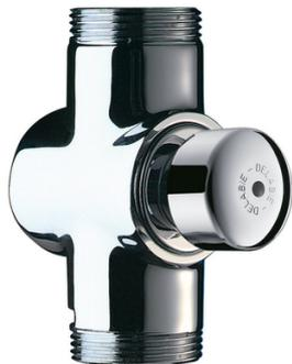
Robinet chasse tempo mâle-mâle 1/1/4 Robinet temporisé de chasse directe à bouton poussoir à poser en applique : Temporisation 7 sec. Protection antisiphonique. Corps et bouton en laiton massif chromé. Mécanisme antichoc. Alimentation en ligne M1\*1/4. Hauteur 110 mm.
