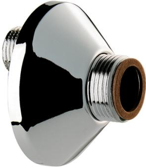
Raccord décalé standard. M1/2" - M3/4". Entraxe 12 mm, L.60 mm. Rosace Ø 70. Laiton massif. Livré par 2 pièces. Garantie 10 ans.
