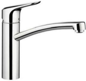
Bec orientable à 360°. Jet normal. Débit : 12 litres/min sous 3 bars de pression. Cartouche céramique M2. Raccordement flexible G3/8. Convient au chauffe-eau instantané.
