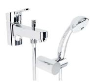
Bec long avec aérateur intégré. Inverseur à retour automatique tout métal. Sortie de douche par le dessous avec clapet anti-retour intégré. Cartouche Ø 47 mm à 2 disques céramique. Avec limiteur de température intégré et limiteur de débit 50 % déverrouillable . Flexibles d'alimentation 350 mm. Système de fixation rapide EASY-FIX. Avec set de douche comprenant douchette anticalcaire 1 jet pluie, flexible laiton 1,5 m, support douchette. Projection 156 mm
