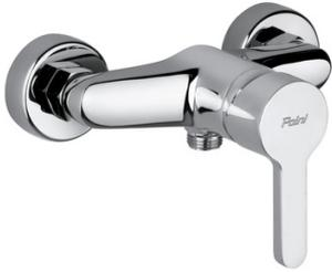
Bénéficie du limiteur de température antibrûlure et de l'ouverture à butée sensitive à 50% du débit permettant de limiter la consommation d'eau. Cartouche Ø 40 mm C2. Raccords excentriques et rosaces laiton Ø 60 mm.
