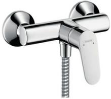
Mitigeur douche C2 avec cartouche à 2 vitesses chromé. 1 sortie = 1 fonction. Type de raccordement: raccords S. Entraxe: 150 mm ± 12 mm. Débit maximal sous 3 bars de pression: 22 l/min. Cartouche céramique à 2 vitesses. Limiteur de température réglable. Clapet anti-retour. Avec silencieux. E1, C2, A2, U3.
