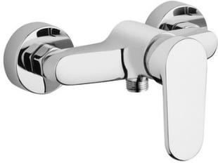
Mitigeur bain douche mural. Manette en métal. Cartouche diamètre 35 mm. Limiteur de débit : Economie d'eau grâce à la butée à 50% du débit. Clapet antipollution sur départ douche. Entretien facile : mousseur anticalcaire. Ouverture avec butée sensitive à 50% du Débit. Clapet antipollution sur départ douche.
