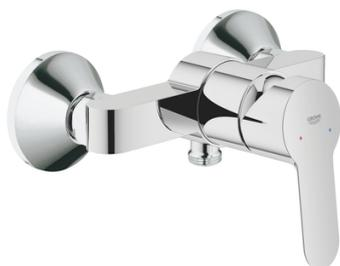
Montage mural apparent. Levier de commande métallique GROHE Long-Life. Cartouche en céramique 46 mm avec butée éco 1/2 débit GROHE Long-Life Shine Chrome éclatant et durable. Clapet anti-retour intégré dans le départ douche 1/2". Raccords en S Rosace métallique.
