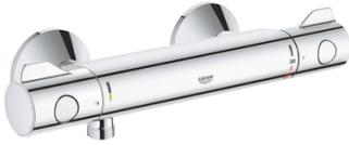
Mitigeur thermostatique douche. Butée 38°C + limiteur de température 50°C. Cartouche C3. Poignée de débit avec touche éco et butée éco réglable séparément. Filtres et clapet anti-retour intégrés. Tête céramique 1/2 180°.
