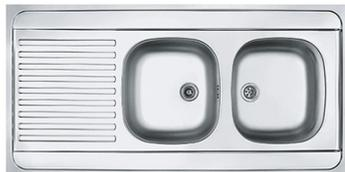
Evier en inox 2 cuves avec 1 égouttoir, réversible. Non percé. Cuves embouties. Isolation phonique par plaques. Vidage comprenant : bondes de diamètre 70 mm et siphon. Bondes manuelles à bouchon chaînette. Bords tombants 30 mm. Cadre bois sur 4 côtés. Garantie 15 ans sur inox. Corrosion et tenue des soudures.
