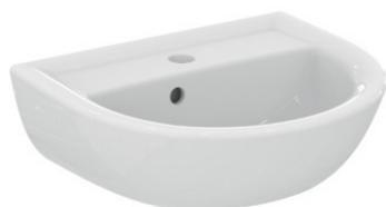
En porcelaine vitrifiée. Percé 1 trou central diamètre 35mm pour la robinetterie. Fixation murale par 2 tire-fond non fournis. Profondeur de la cuve: 11,5cm.
