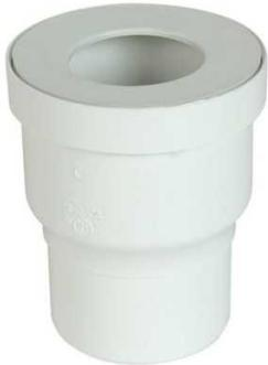
Le raccord pour sortie droite de Nicoll permet le raccordement d'un WC avec le conduit d'évacuation. Doté d'un joint à lèvres en élastomère, il convient à un raccord Ø 87 à 107 mm.
