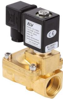
Électrovanne normalement fermée à action directe. Compatible : eau, air et fioul. Alimentation : 220V. Diamètre Raccord : 1". Diamètre passage : 25 mm. Pression différentielle max. : 13. Pression fonctionnement : 0.5 à 13 bars. Pression maxi : 16 bar. Matériel corps : Bronze. Membrane : NBR. Mode opération : Commande indirecte. Type : Normalement fermée. Protection IP : IP65.
