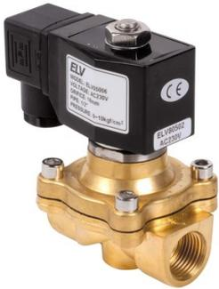
Électrovanne normalement fermée à action directe. Compatible : eau, air et fioul. Alimentation : 220V. Diamètre Raccord : 1/2". Diamètre passage : 16 mm. Pression fonctionnement : Eau 0 à 10 bars - Air 0 à 10 bars Fioul 0 à 5 bars. Pression maxi : 16 bar. Matériel corps : Bronze. Membrane : NBR. Mode opération : Commande directe. Type : Normalement fermée. Protection IP : IP65.
