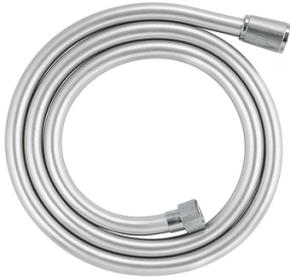
1750 mm; Surface lisse pour un nettoyage facile. Résistance aux torsions jusqu'à 500N. Résistance à la pression jusqu'à 5 bars. Résistance à la chaleur 70°C. Anti-plieres résistant aux plieres. Connexion universelle G 1/2" x 1/2". Système anti-torsion Twistfree
