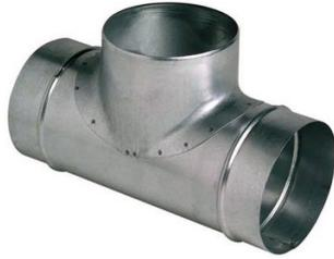
Accessoire mâle à raccorder par emboîtement pour les réseaux de ventilation. Compatible avec les conduits CMS. Doté de 3 connexions de diamètres 100 mm. Permet de changer de direction. Robuste, en acier galvanisé sans joint.
