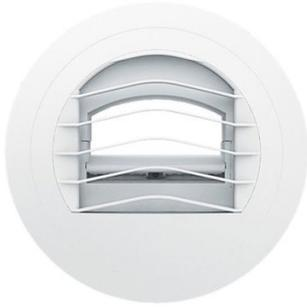
Permet l'extraction de l'air vicié. S'installe sur parois horizontales ou verticales. En polystyrène blanc. Equipé d'une grille centrale amovible pour faciliter l'entretien. Débit d'extraction déterminé de 75 m<sup>3</sup>/h. Dotée d'une manchette placo de diamètre 125 mm.
