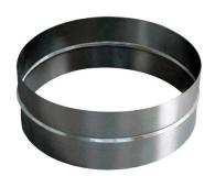
Ce raccord femelle de diamètre 160mm ou 200mm, permet de raccorder les conduits rigides circulaires des réseaux aérauliques. En acier galvanisé standard et facile à monter, par simple emboitement, il participe à la bonne étanchéité des réseaux VMC collective et tertiaire.
