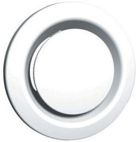
Permet l'extraction et l'insufflation de l'air de votre logement, lors de l'application de climatisation ou de ventilation. Dotée d'un obturateur mobile, réglable par une vis centrale. Débit réglable sur une plage de 15 m<sup>3</sup>/h à 140 m<sup>3</sup>/h. Équipée d'une manchette à griffes.
