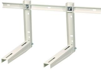
Support équerre prémonté de couleur blanche RAL (9002), doté d'une barre 800 mm et d'un kit de fixation. Compatible avec l'unité extérieure du chauffe-eau Calypso Connecté Split Inverter et les climatiseurs de taille 7 à 18. En tôle métallique d'épaisseur 1,5 mm, peut supporter une charge de 160 kg.
