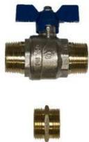
Contient 1 vanne 26 × 34 mm et 1 mamelon 26 × 34 mm. Le mamelon permet de se connecter entre le groupe extérieur et l'unité intérieure, il sera à monter sur la vanne livrée avec le module intérieur. La vanne 1 assurera la connexion entre l'installation et le kit Hydrofast et se positionnera sur le retour direct au groupe extérieur.
