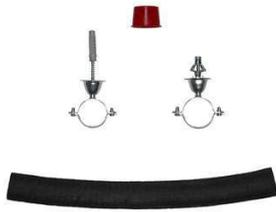
Contient : tuyaux, 4 bouchons ABS (pour éviter l'insertion de gravats dans le tuyau), colliers, rosaces, pattes à vis, chevilles crampon et chevilles à compression pour plaque de plâtre et pattes à vis métaux. Kit conçu pour amener toutes les solutions de fixations quel que soit le support. Il a été prévu de positionner un collier tous les 50 cm. En cas de courbe, nous vous conseillons de positionner un collier de part et d'autre de l'axe du coude à 15 cm.
