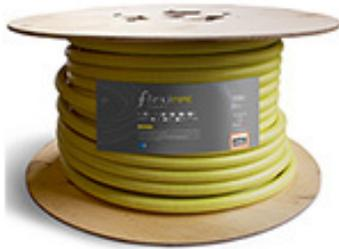
Tuyau FLEXIPIPE annelé en acier inoxydable. Pression maximale d'utilisation du calibre 10 au calibre 25 : 2 bar. Pression maximale d'utilisation du calibre 32 au calibre 50 : 500 mbar.
