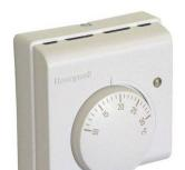
Thermostat d'ambiance mural avec réglage simple par molette de consigne. Courant jusqu?à 10 A (résistif) ou 3 A (inductif). Commutateurs de "change-over" pour les applications de climatisation ou de chauffage / climatisation. Réglage de la température : 10 à 30°C.
