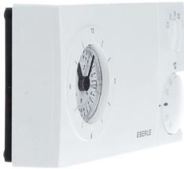
Utilisation aisée. Réglage séparé des températures jour et nuit. 5 modes de fonctionnement par sélecteur rotatif : confort permanent, réduit permanent, automatique, hors-gel, arrêt. Existe en hebdomadaire ou journalier. Couvercle pivotant. Mode tout ou rien. Sortie relais 1 inverseur. Nouveau design E 2000.
