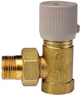
Corps laiton. Température maxi : 110°C. Pression maxi : 10 bar. Puissance maxi : 100 kW. Réglage : 1 à 6 mce. Diamètre raccord : 3/4" MF. Puissance installation : 46 kw / 40 000 kcal/h.
