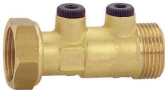
Comprend: Corps laiton muni de 2 bossages Bouchons polyamide Clapet polyacétal (POM) Ressort acier inox Joint NBR (nitrile).
