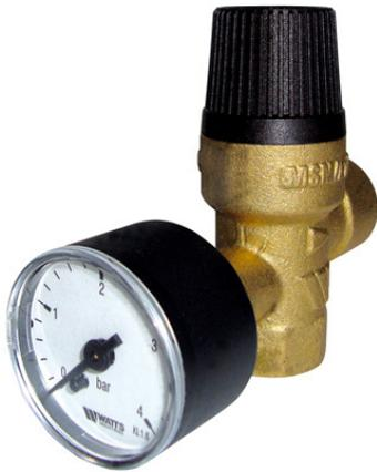
Soupape chauffage-mano 3 bar. Soupape de sécurité en laiton, à membrane avec manomètre. Manomètre 0 - 4 bar. Corps et couvre-ressort en laiton. Ressort en acier. Tarage 3 bar. Entrée et sortie Femelle/Femelle.
