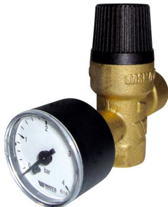
Pour la régulation de la pression dans le circuit de chauffage. Puissance : 120 kW. Corps et couvre-ressort en laiton. Ressort en acier. Entrée et sortie femelle. Température : -10°C à +110°C.
