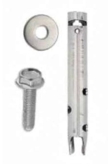
Cheville acier zingué à frapper de Ø16 mm, écrou rondelle et vis à tête hexagonale de 10x30 avec rondelle large. Longueur : 120 et 160 mm : montage parpaings, briques creuses ou pleines, béton cellulaire, pierres tendres. 200 et 240 mm : montage parois isolées . Boîte de 4.
