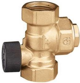
Clapet antithermosiphon en laiton à sortie droite ou équerre. Température maxi : 110°C. Pression maxi : 10 bar. Glycol : maxi 30%. Débrayable (ouverture manuel du clapet). Pression d'ouverture : 0,02 bar.
