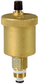
Purgeur d'air automatique en laiton équipé d'un véritable mécanisme à pointeau avec ressort de rappel et joint torique détaché. Avec clapet automatique. Température maxi 110°C. Pression maxi 10 bar.
