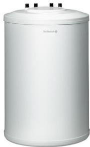
Préparateur d'eau chaude sanitaire à hautes performances. Posé au sol sous chaudière. Cuve et échangeur serpentin incorporé en acier protégés par une vitrification à haute teneur en quartz de qualité alimentaire : trappe de visite, anode en magnésium, isolation en mousse de polyuréthane injectée de forte épaisseur exempte de CFC, habillage en tôle d'acier laquée classé MO.
