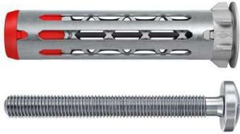
Flexible lors du montage : la vis peut être desserrée et resserrée. Pas de rotation : des ailettes anti-rotation maintiennent la cheville dans la plaque lors de l'installation. Convient pour le montage en attente. Installation simple avec une visseuse. Pour plus de simplicité, une seule longueur de cheville convient pour toutes les épaisseurs de plaques de 9,5 à 30 mm.
