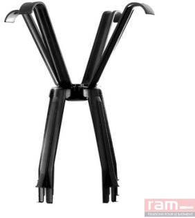
Ramspot est un accessoire permettant la pose de spot encastrable sur plaque de plâtre dans un plafond isolé par la laine de verre ou par la laine de roche en rouleau. Il crée un volume d'air suffisant et nécessaire à la dissipation de chaleur. La pose du RAMSPOT se fait par en dessous, sans accès aux combles.
