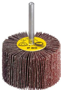
Roue à lamelles sur tige, outil de grande qualité pour de multiples applications. Nature du grain : Corindon. Liant : Résine synthétique. Utilisation : Métal. Possible utilisation: Bois, matière plastique. Tige de 6 mm.
