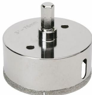
Trépan à tête cannelée diamantée. Perçage uniquement à eau, horizontal ou vertical. Tête entièrement diamantée par dépose électrolytique. Munis d'une tige ronde de 6 mm ou hexagonale pour le montage sur perceuse portable. Très bonne vitesse de perçage et excellente finition dans les matériaux de décoration tels que céramique, grès, faïence, verre, composite, marbre, granit. Orifices d'extraction de la carotte.
