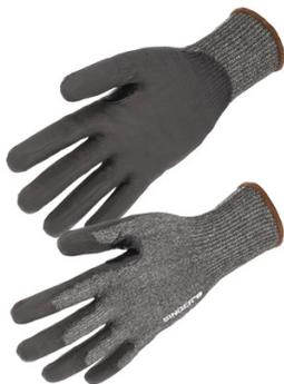
Applications : entretien maintenance, industrie légère, industrie lourde, second oeuvre. Jauge 13. Support tricoté une pièce (sans couture). Support en fibres haute ténacité HDPE. (Polyéthylène haute densité PEHD) et autres fibres techniques. Enduction polyuréthane sur la paume. Renfort nitrile entre le pouce et l'index. Poignet élastique. Niveau 5 Anti-coupure
