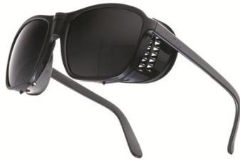
Sa monture nylon à vis caractéristique fait de l'UNIVIS 10 l'un des incontournables de la protection. Le remplacement des oculaires est ainsi un jeu d'enfant : les oculaires asymétriques se fixent à droite comme à gauche. Monture à vis. Oculaires asymétriques interchangeables. Solidité renforcée : résistance aux chocs d'une bille d'acier de diamètre 22mm et de minimum 43g à une vitesse d'environ 5.1m/s.
