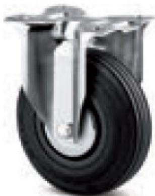
Roulette en acier embouti, finition zinguée, version pivotante avec pivot sur double chemin de billes, axe boulonné. Fixation à platine. Corps de roue polypropylène, bandage : caoutchouc semi élastique noir. Dureté Shore du bandage : 85A. PVH : moyeu lisse avec pare-fils - PVJ : roulements rouleaux avec pare-fils. Dimensions platine : 103 x 85. Entre axes : 80/77 x 60. Diamètre des trous : 9 mm.
