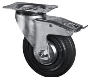
Roulette en acier embouti, finition zinguée, version pivotante avec pivot sur double chemin de billes, axe boulonné. Fixation à platine. Corps de roue polypropylène, bandage : caoutchouc semi élastique noir. Dureté Shore du bandage : 85A. PVH : moyeu lisse avec pare-fils - PVJ : roulements rouleaux avec pare-fils. Dimensions platine : 105 x 85. Entre axes : 80/77 x 60. Diamètre trous : 9 mm.
