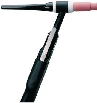
Torche à refroidissement à air. Capacité en courant continu (DC): 140 A. Capacité en courant alternatif (AC): 125 A. Facteur de marche : 60 %. Electrode de tungstène : Ø 0,5 à 4 mm.
