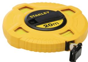
Ruban en fibre de verre renforcé (40 brins au lieu de 26) pour une élasticité réduite et une plus grande précision. Ruban jaune fluo pour une visibilité plus grande. Ruban avec revêtement PVC, insensible à la corrosion, traité anti-UV et non conducteur d'électricité. Classe III. Graduation tous les 2 mm. Boîtier ABS antichoc. Boîtier ouvert pour un entretien à l'eau facile et rapide.
